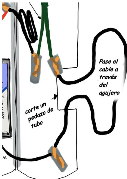
4. Corte el cable y retire el plástico de los extremos cortados, con cuidado de no dañar el cable.
